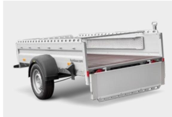
Klappe mit versenkten Verschlüssen
