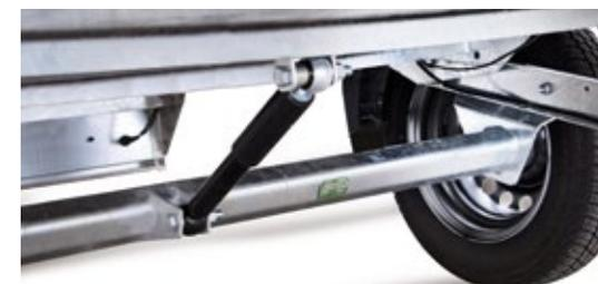
Kippbarer Kastenaufbau (beim HA kippbar) mit Stoßdämpferunterstützung
