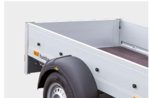
Bordwände aus eloxiertem, doppelwandigem Aluminiumprofil
