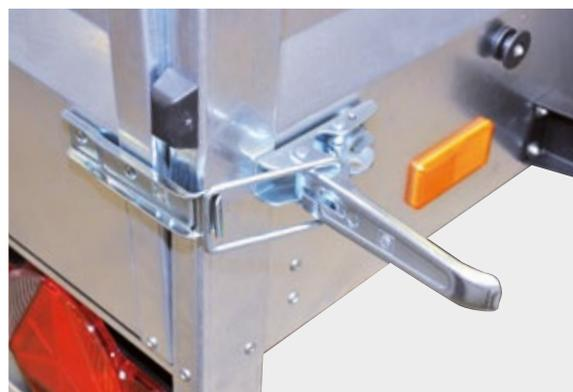
Spannverschlüsse an der Heckklappe
