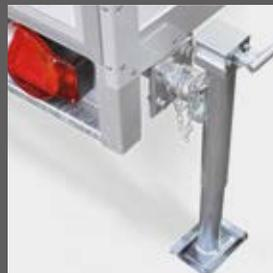
Teleskopkurbelstützen für Kofferanhängler (2 Stück)
