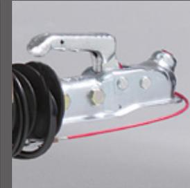
Kugelkopfkupplung für höhenverstellbare Zugdeichsel
