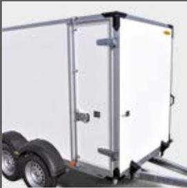
Seitentür mit Drehstangenverschluss von Innenhöhe 1500 - 2300 mm
