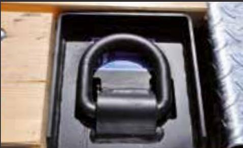
Zusätzlicher im Brückenboden versenkter Zurrpunkt
