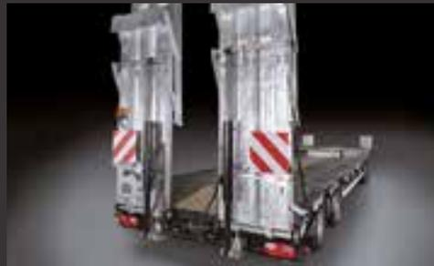
2-teilige hydraulische Rampen mit hydraulischer Seitenverschiebung
