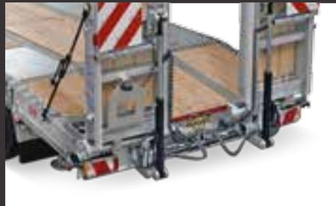
1-teilige hydraulische Rampen mit hydraulischer Seitenverschiebung
