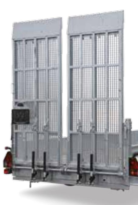
Einteilige, breite Rampen mit Stahlgitterrost
