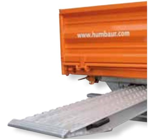
2 Aluminium-Rampen, unter der Ladefläche einschiebbar
