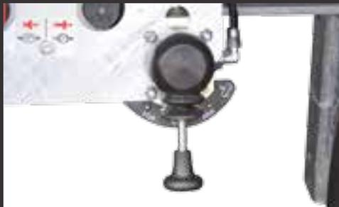
Luftfederung mit Heben/Senken Funktion
