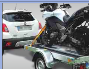
TL-MU-P2 mit Standschiene für Motorräder
