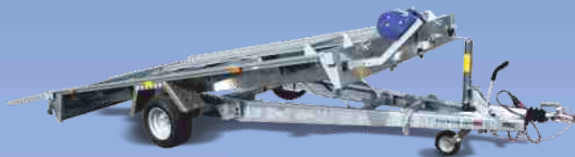
Abb.: HL-EBK 3520/15 mit Radstoppnern und Seilwinde (Zubehör)
