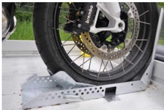
Optionale Motorradwippe zur Festmontage auf der Ladefläche
