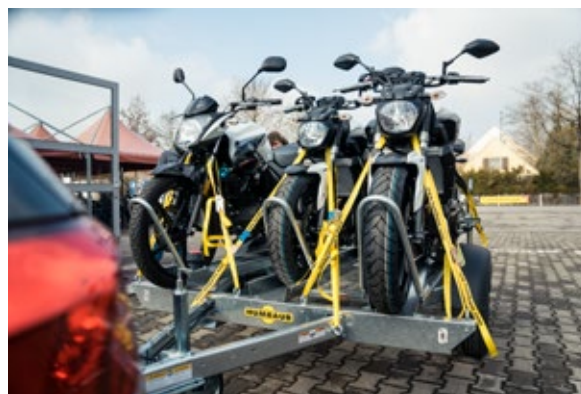
3 Standschienen mit Bügel montiert
