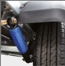
Radstoßdämpfer inkl. 100 km/h Bestätigung
