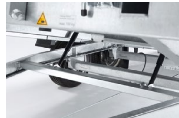
Brücke mit speziellem Kipplager
