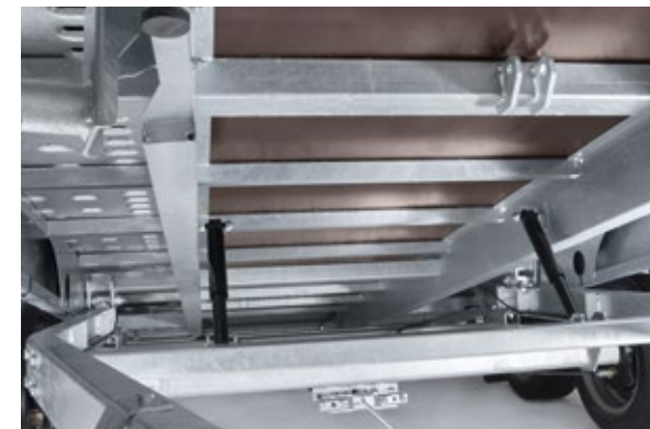
Extreme Stabilität durch eine geboltze, genietete und verschraubte Brücke mit durchgehenden Brückenlängsträgern
