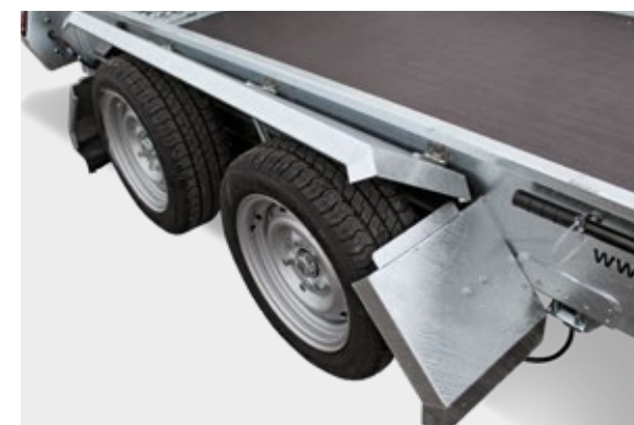
feuerverzinkte Überfahrwand mit rutschhemmendem Gitterbelag, sowie mit Gasfederunterstützung
