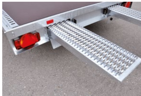
Auffahrbohlen aus Stahl feuerverzinkt
