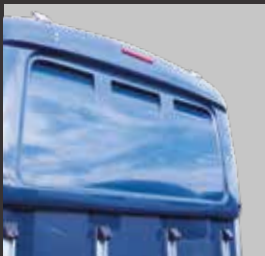
GFK-Windflap mit integrierter dritter Bremsleuchte (optional) für Balios®, Xanthos®, Zephir® und Maximus®
