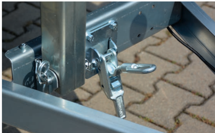
Befestigung der Kippbrücke über Sicherungsspannverschluss.
