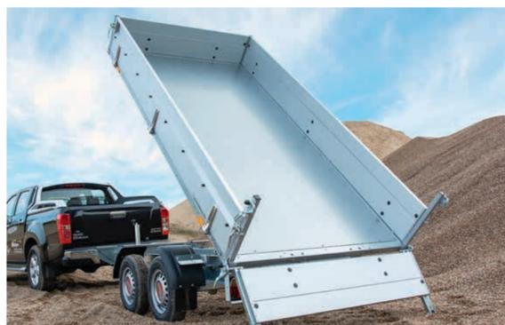
Wasserfester Holzboden mit zusätzlich verzinkter Stahlblechauflage.
