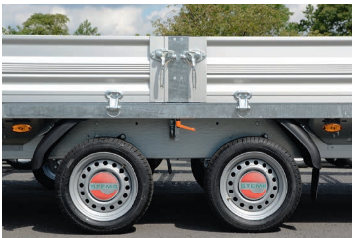
mit herausnehmbaren Mittelrungen
