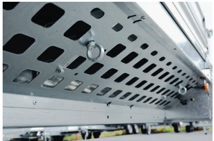
Verkleidungsbleche mit Langlöchern & Ringmuttern
