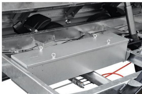
Pumpenaggregat geschützt vor Steinschlag & Spritzwasser
