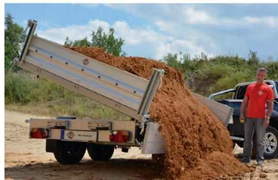
allseitig abklapp- und abnehmbare Bordwände
