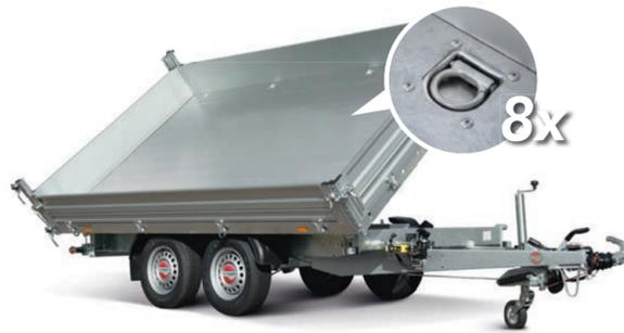
verzinkter Stahlblechboden mit versenkten Schwerlast-Zurringen
