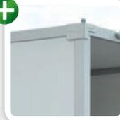
stabiler Kofferaufbau mit breitem ALU-Rahmen und Eckverstärkung, wasserdicht verklebt.
