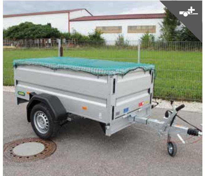
Bordwandaufsatz mit Ladungssicherungsnetz und Netzhaken
