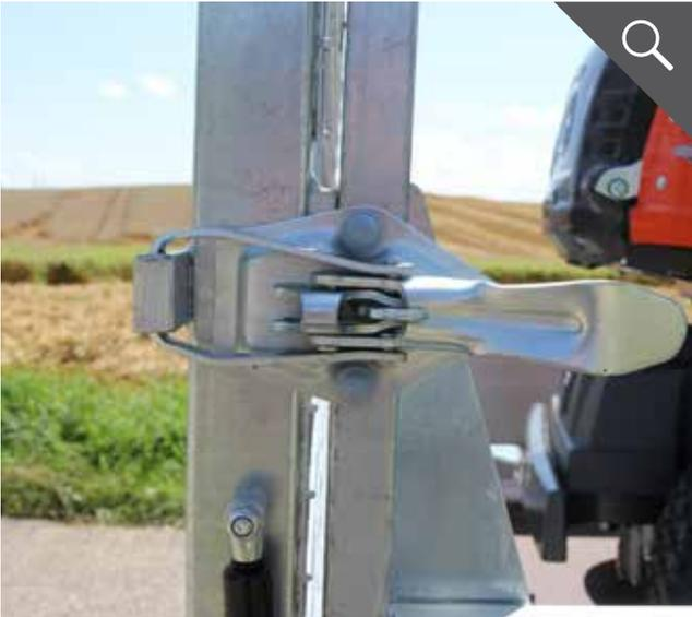
Verzinkter Spannverschluss für Auffahrklappe
