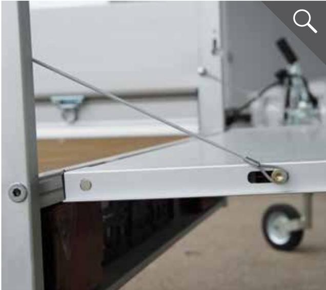
Bordwandseil für Heckklappe
