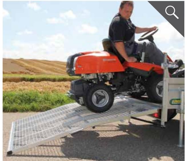
Gitterklappe mit einer Tragkraft von 500 kg für luftbereifte 4 Rad Fahrzeuge
