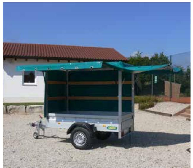
Sonderbau: Kastenanhänger mit Planenaufbau als Verkaufsstand
