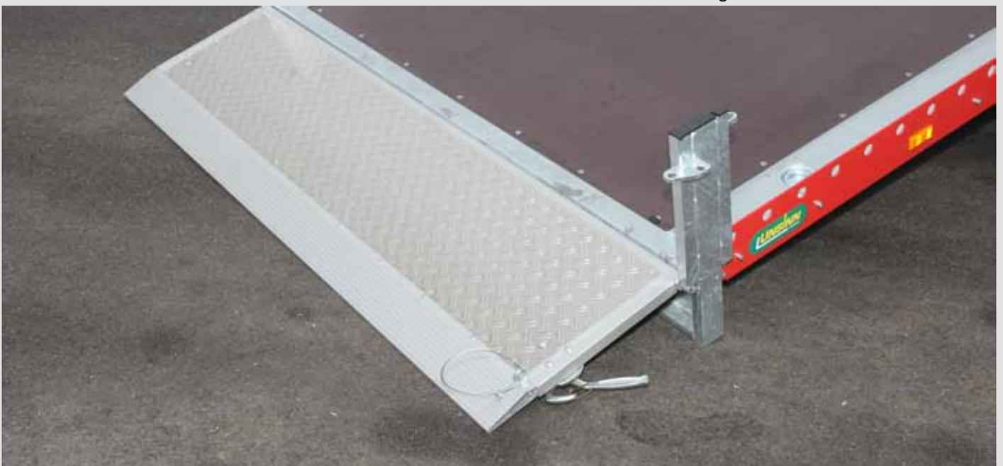
durchgehende Auffahrklappe mit rutschhemmendem Riffelblech
