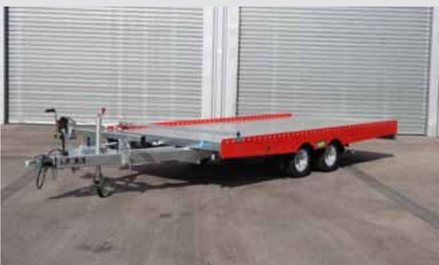
verschweißter und feuerverzinkter Stahlrahmen
