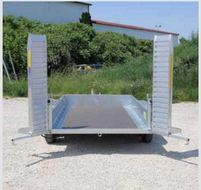
Auffahrrampen komplett wegschwenkbar
