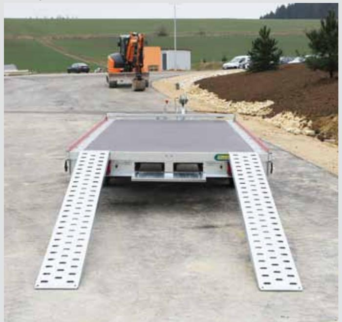
Auffahrschienen mit 2400 kg Tragkraft
