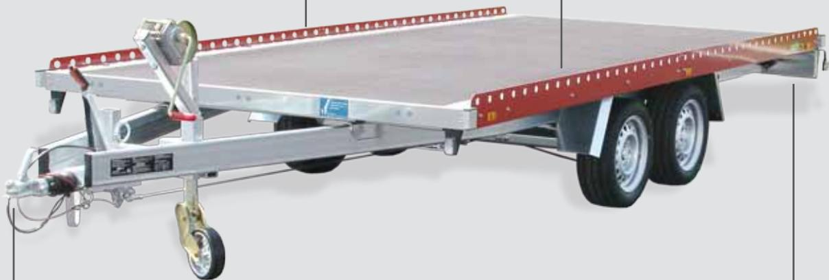
Stabiles Automatikstützrad (500 kg) für sicheres Abstellen und leichtes Rangieren.
