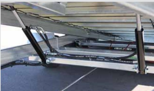
Doppelte Hydraulik für gleichmäßiges Abkippen
