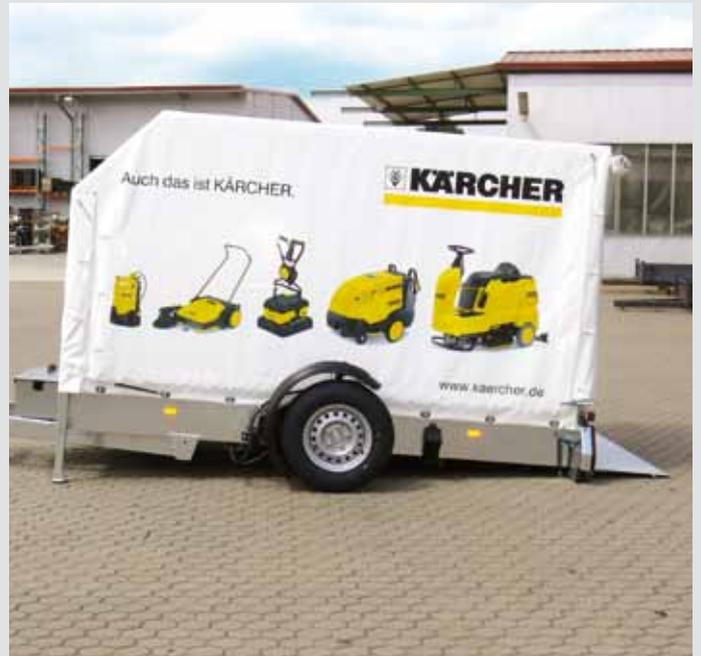
Absenkanhänger Typ GAS mit Planenaufbau
