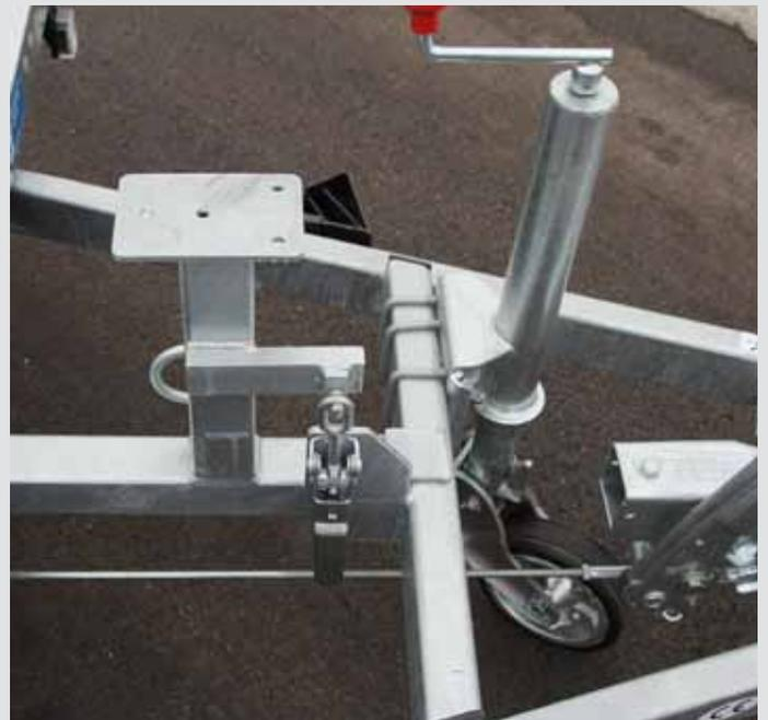
Windenbock mit Sicherungshebel
