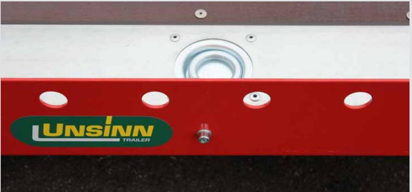
Zurpunkte an der Reling mit 400 kg Zugkraft
