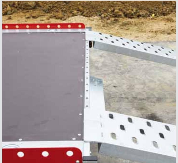
Lochleiste für Auffahrschienen als Abrutschsicherung
