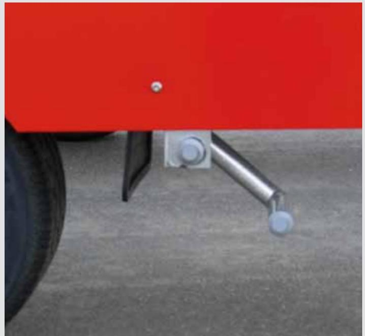
Hebel zum Entriegeln der Auffahrampen
