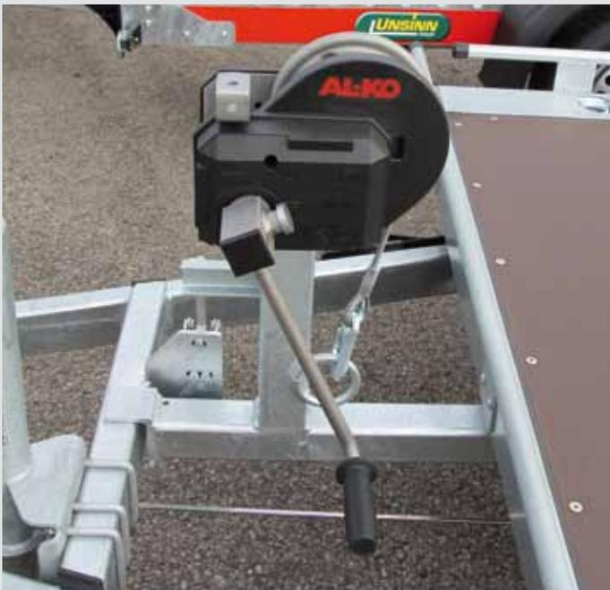
Seilwinde auf Windenbock montiert
