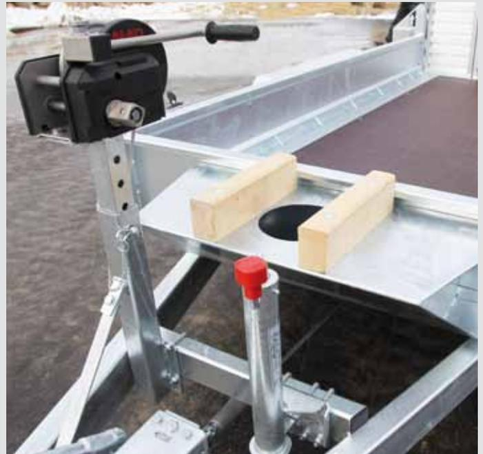
Baggerarmauflage, Windenbock mit Handseilwinde
