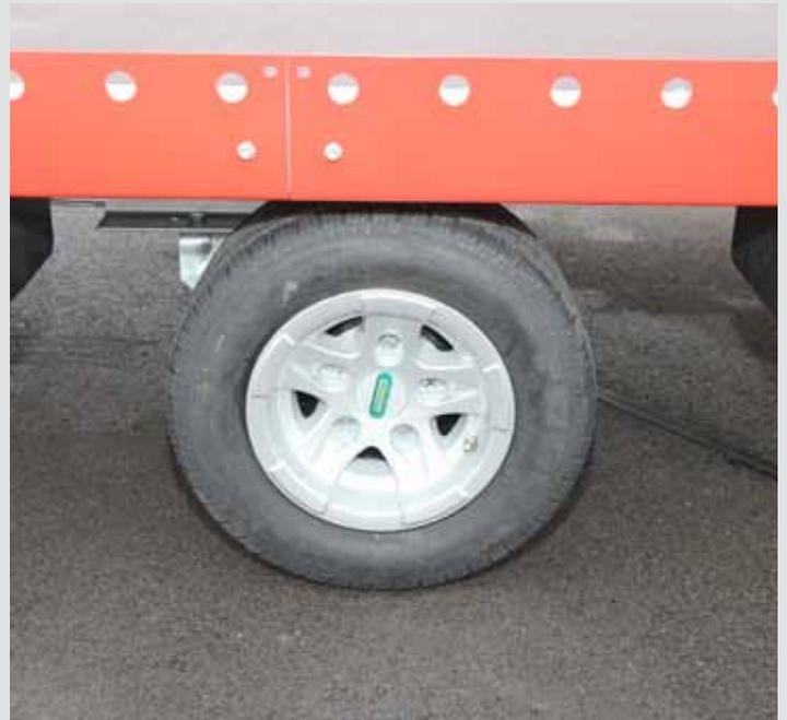
versenkte Zurpunkte in der Ladefläche mit 600 kg Zugkraft 10 Zoll Bereifung für eine niedrige Beladehöhe
