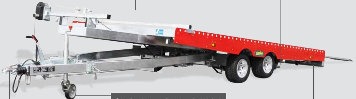
Stabiles Automatikstützrad (500 kg) für sicheres Abstellen und leichtes Rangieren.
