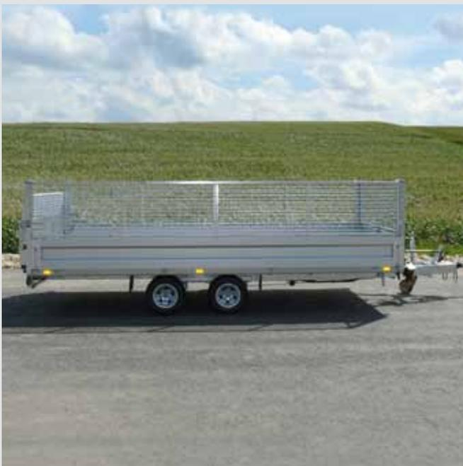
Gitteraufsatz für Schnittgut
