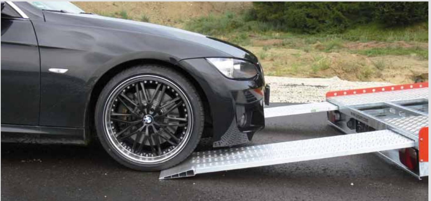
geringer Auffahrwinkel für Fahrzeuge mit wenig Bodenfreiheit
