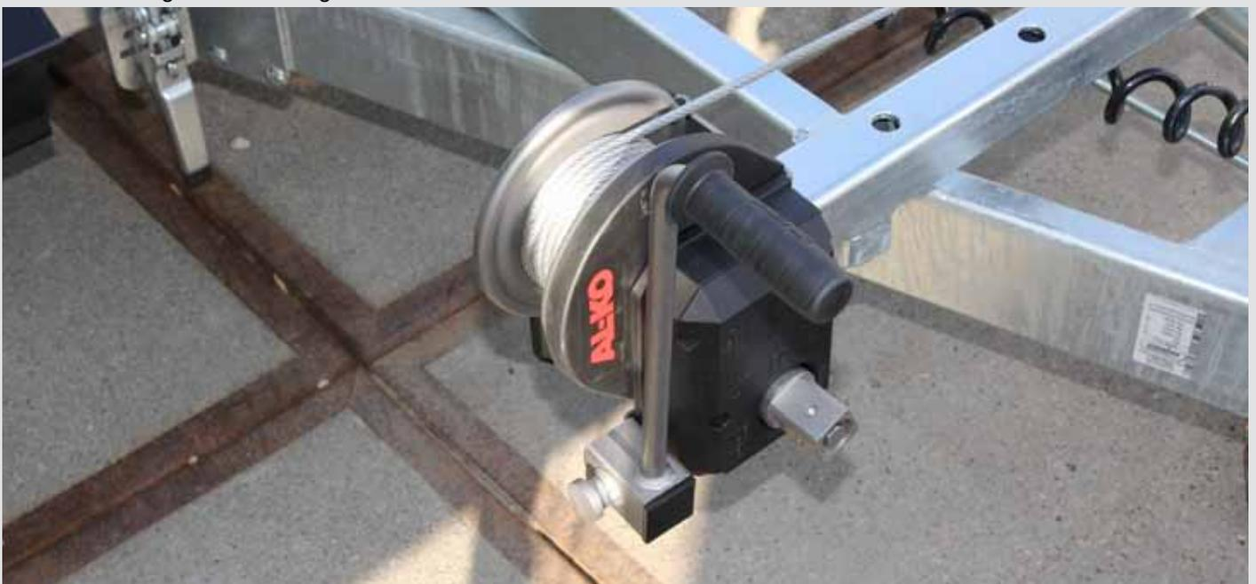
Seilwinde für leichtes beladen
