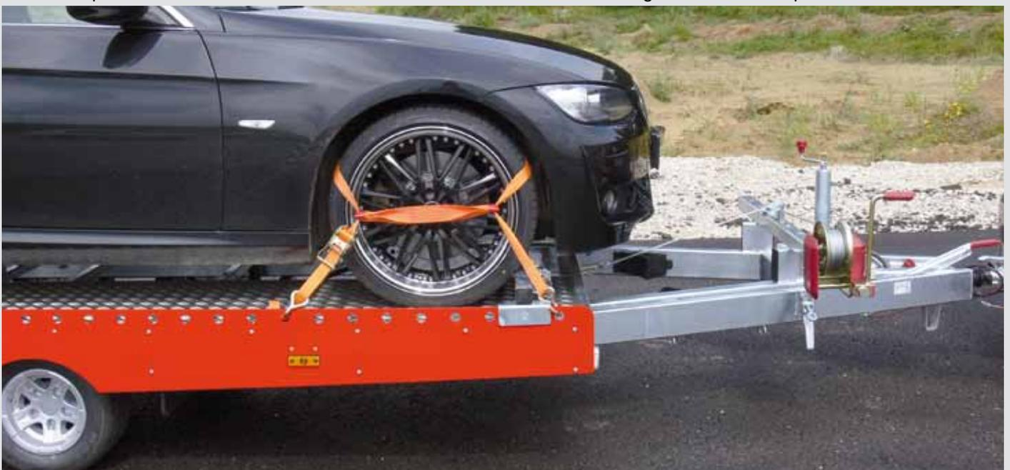
flexible Verzurrmöglichkeiten der Radsicherungsgurte
