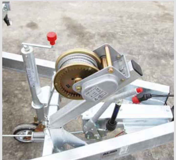
Handseilwinde mit 900 kg Zugkraft
