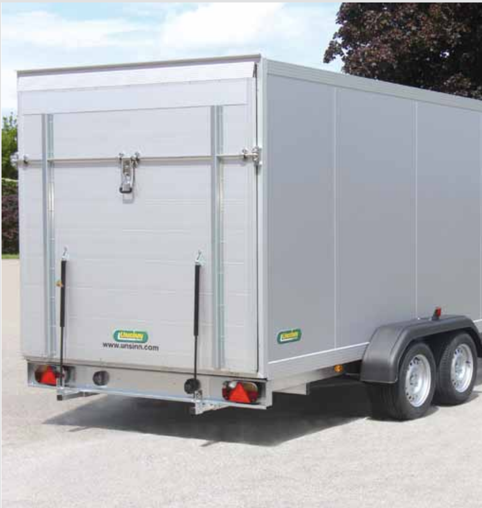
Gasfederhubhilfe bei Auffahrklappe
