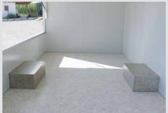
PVC Boden und Radkästen
