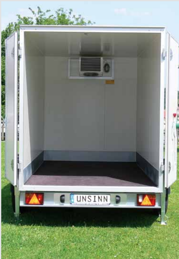
rutschhemmende Bodenplatte mit Scheuerleiste
