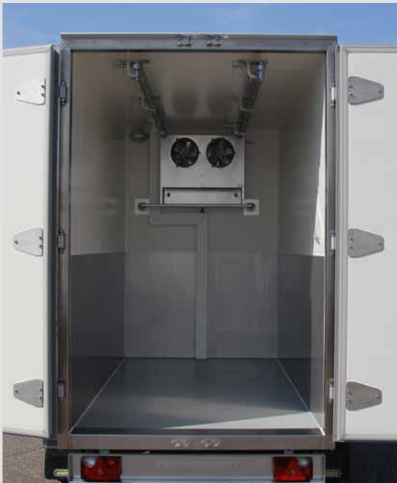
rutschfester und wasserabweisender Bodenbelag, lebensmittelecht
