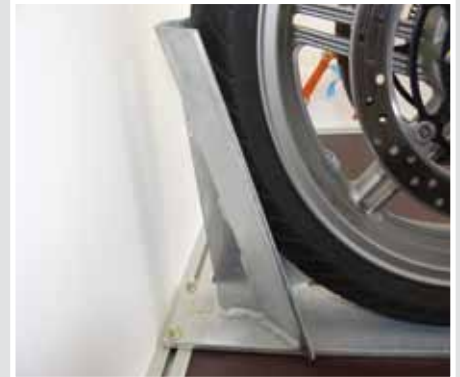
Radanschlag für Zweiräder
