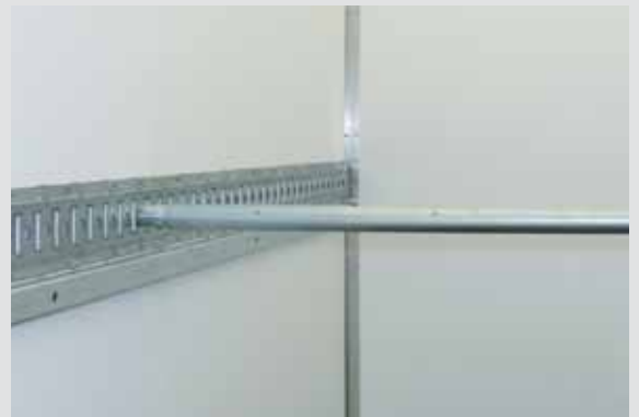
Sperrstange zur Ladungssicherung
