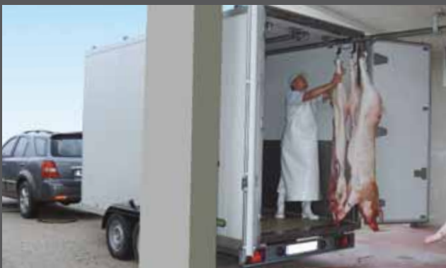
Dachrohrbahn für einfaches, direktes Beladen
