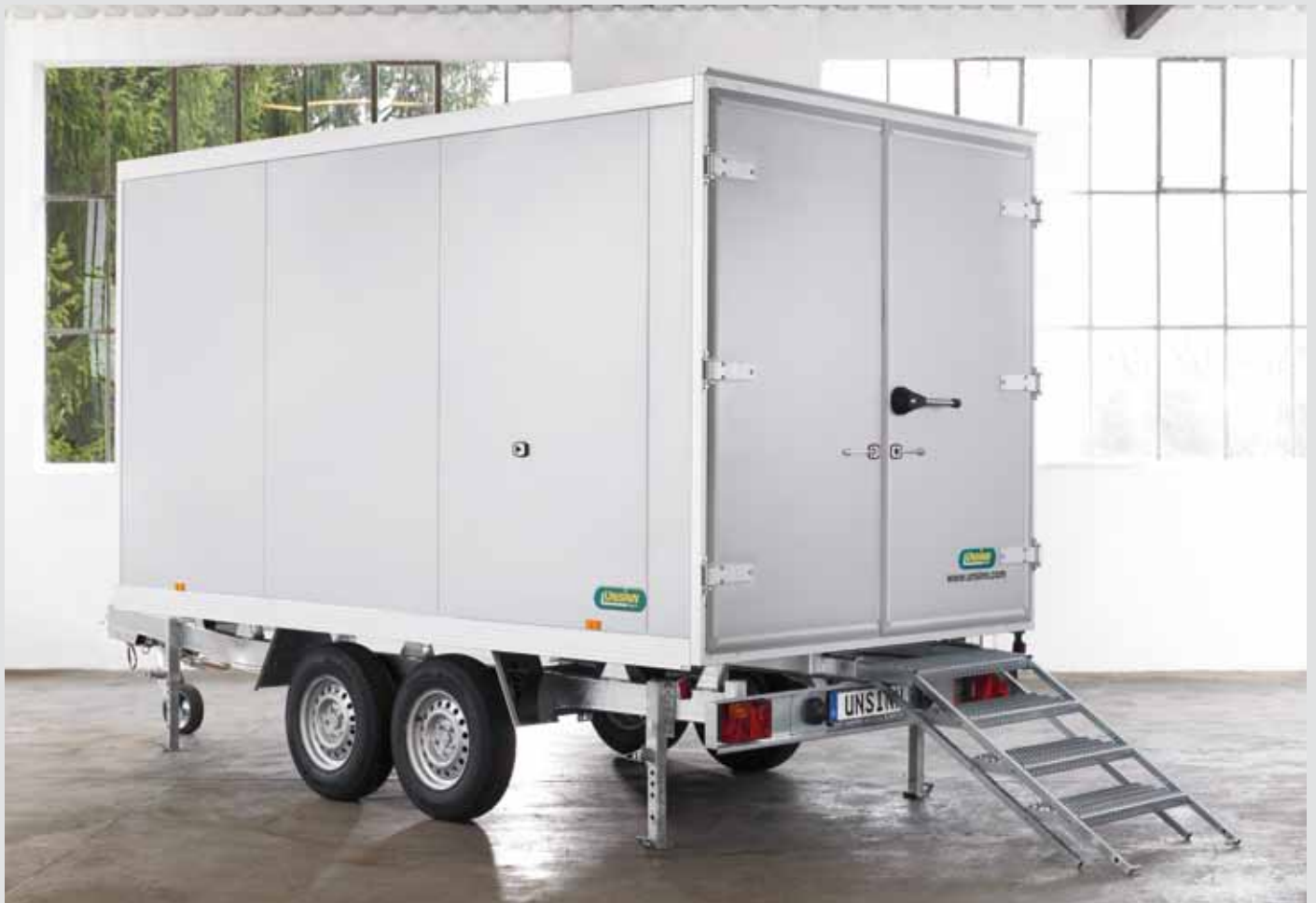
Treppe unterhalb der Ladefläche für einfaches Betreten des Anhängers
