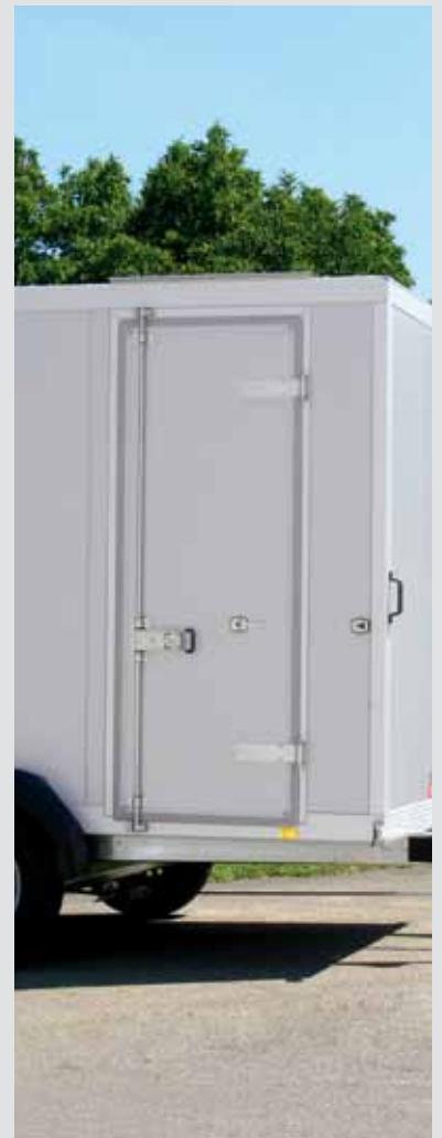
Türe mit Drehstangenverschluss
