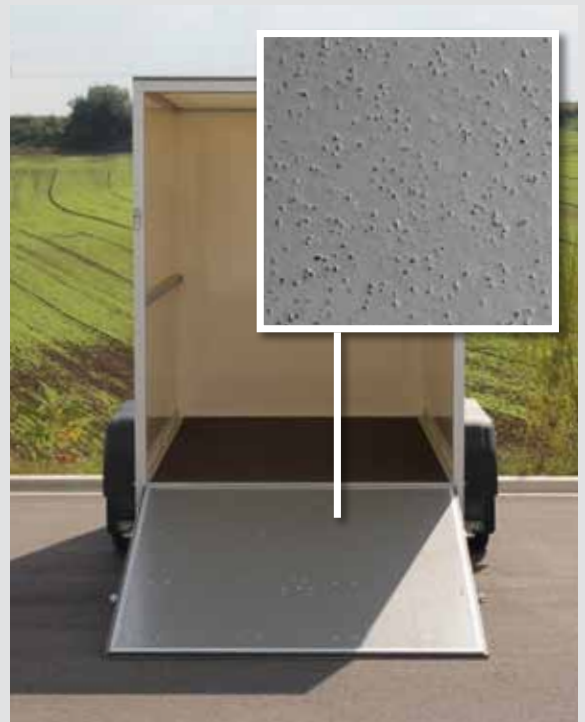
hochwertige rutschhemmende Oberfläche
