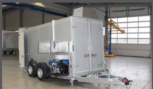
Typ GTASK mit Kühl- und Stromaggregat
