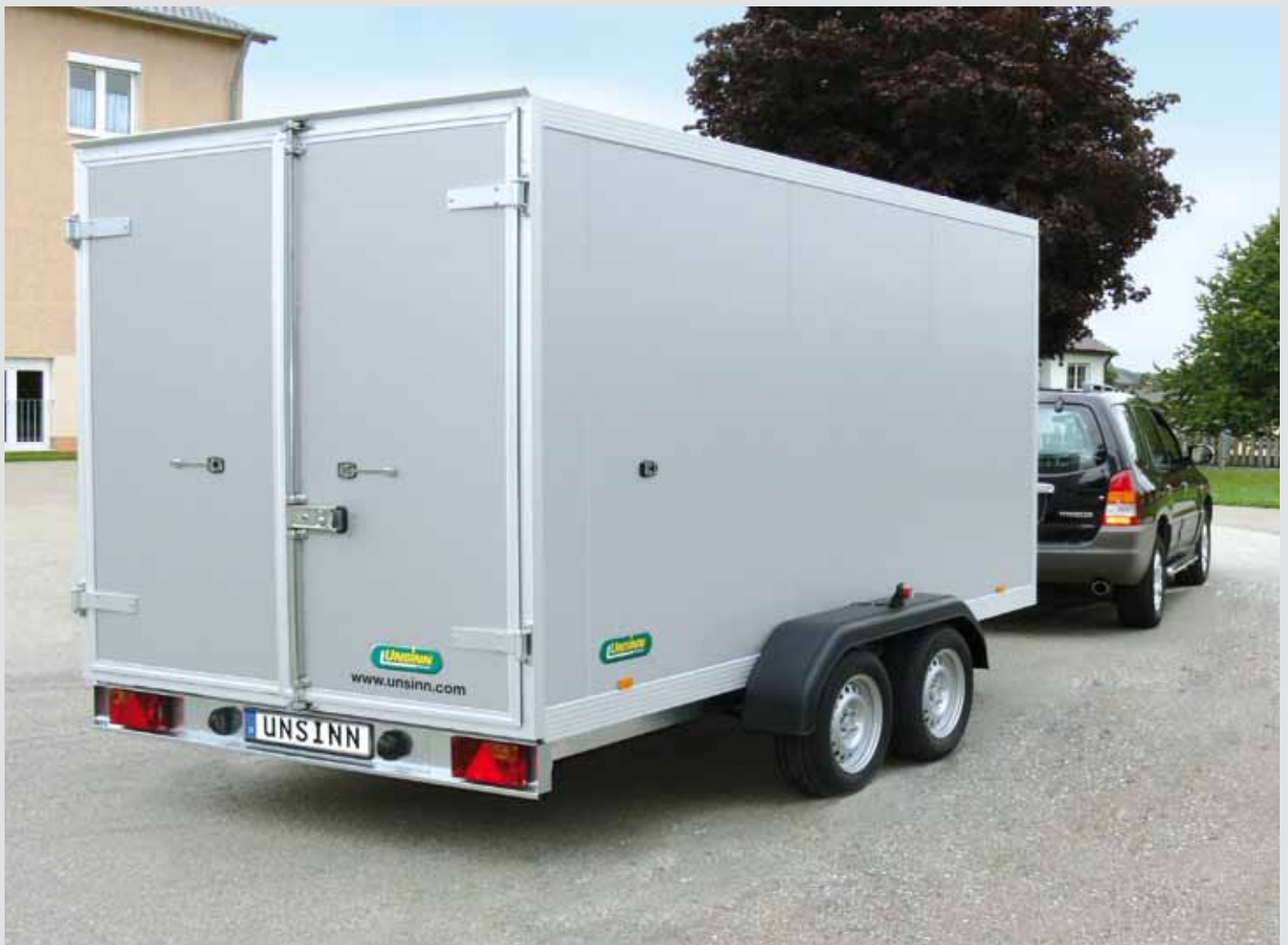
Türen mit Drehstangenverschluss - absperrrbar
