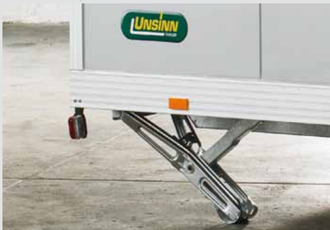
Kurbelstützen unterhalb der Ladefläche montiert
