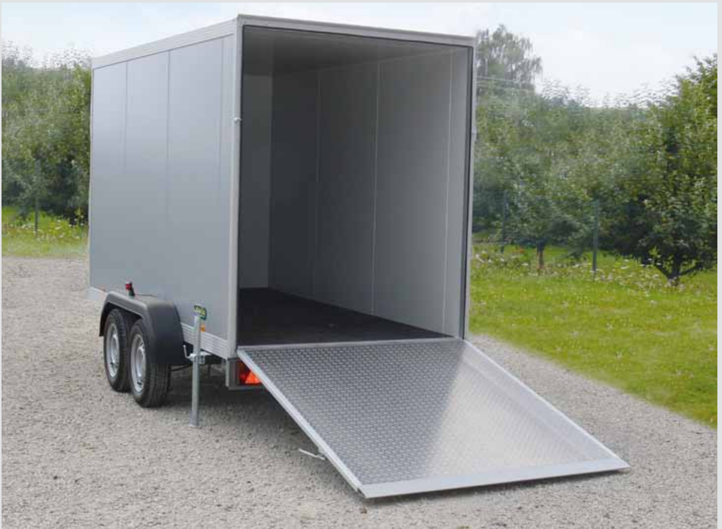
Auffahrklappe mit rutschhemmender Oberfläche
