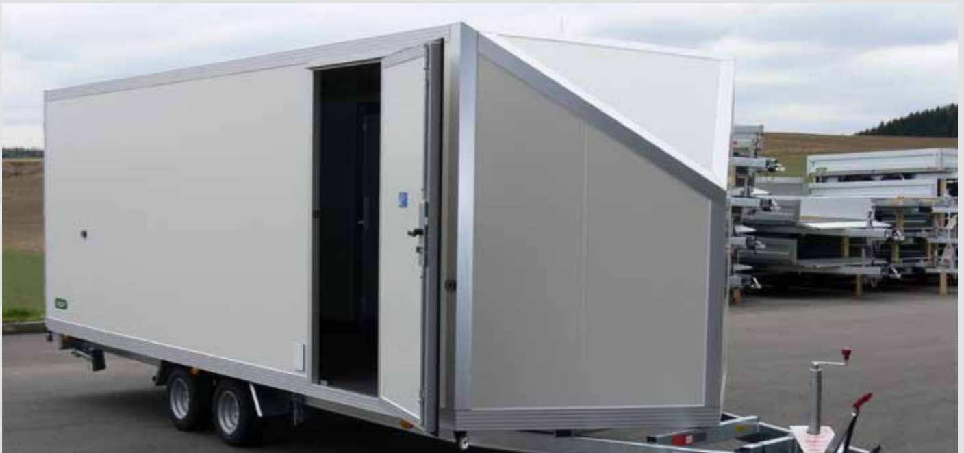
spitze und abgeschrägte Stirnwand
