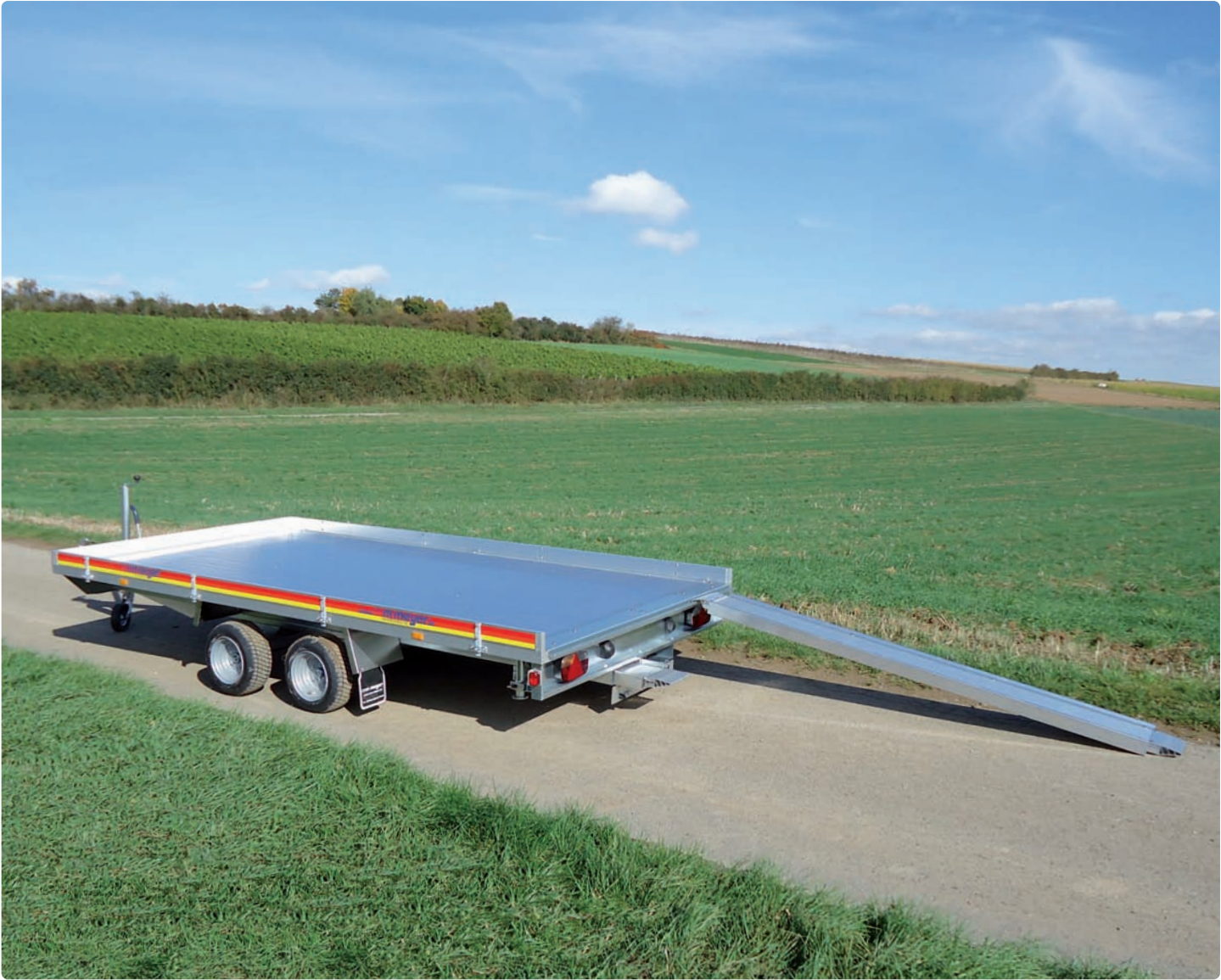
APHLC 2741/210 2 Aluauffahrschienen, Stützrad verstärkt (klappbar, mittig), Aluprofilboden APHLC 2741/210 2 rampes en alu, roue jockey renforcée (automatique, au milieu), plancher en profilés d'aluminium APHLC 2741/210 2 aluminium skids, reinforced jockey wheel (automatic), aluminium profile platform
