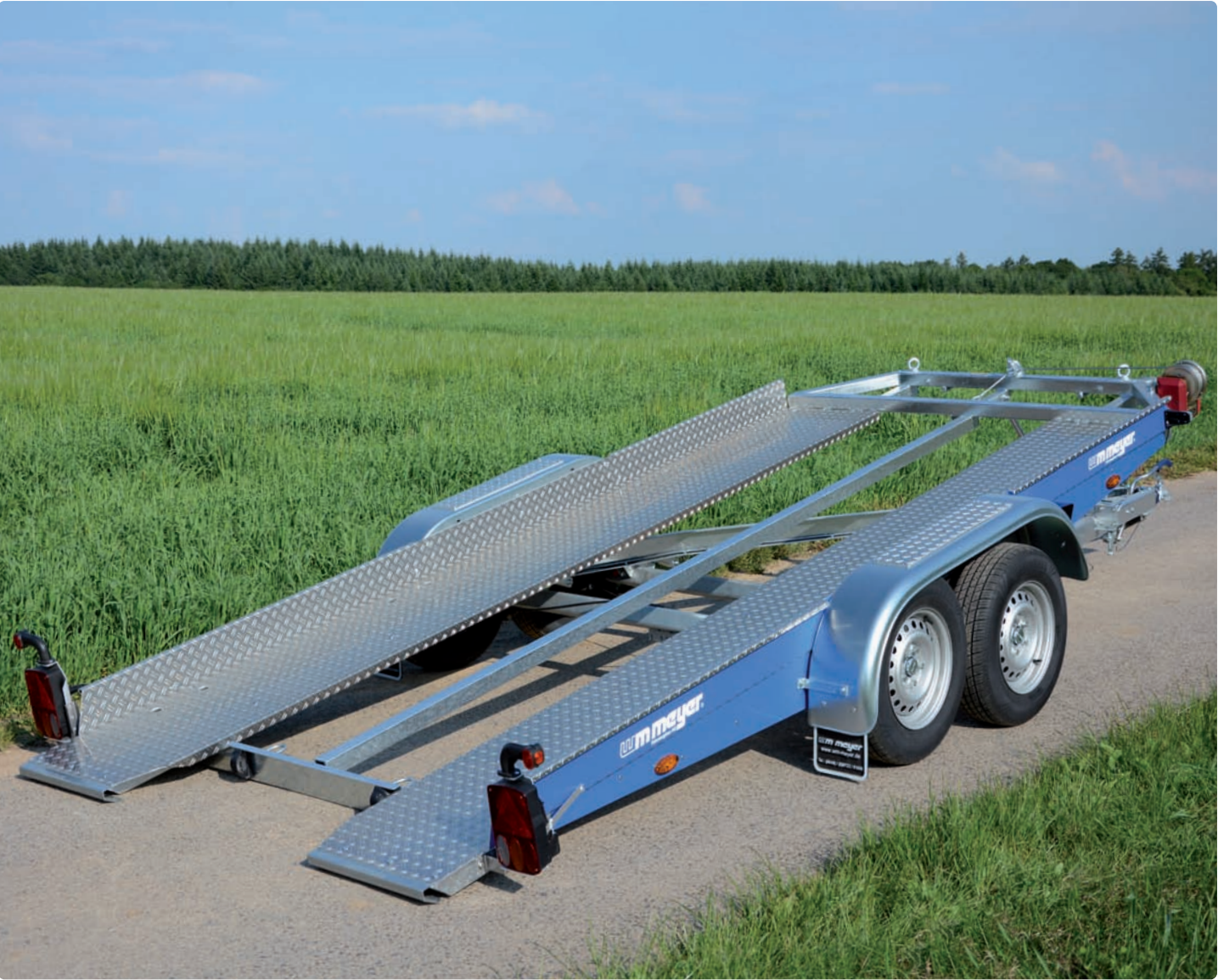
AK 2700 B Royal Blue Verstärkte Kotflügel (Stahl verzinkt), elegante Seitenblenden (signalblau, RAL 5005) AK 2700 B Royal Blue Garde-boues renforcés en acier galvanisé, plinthes latérales élégantes (bleu signal, RAL 5005) AK 2700 B Royal Blue Reinforced mudguards made of galvanised steel, elegant side panels (similar to signal blue, RAL 5005)
