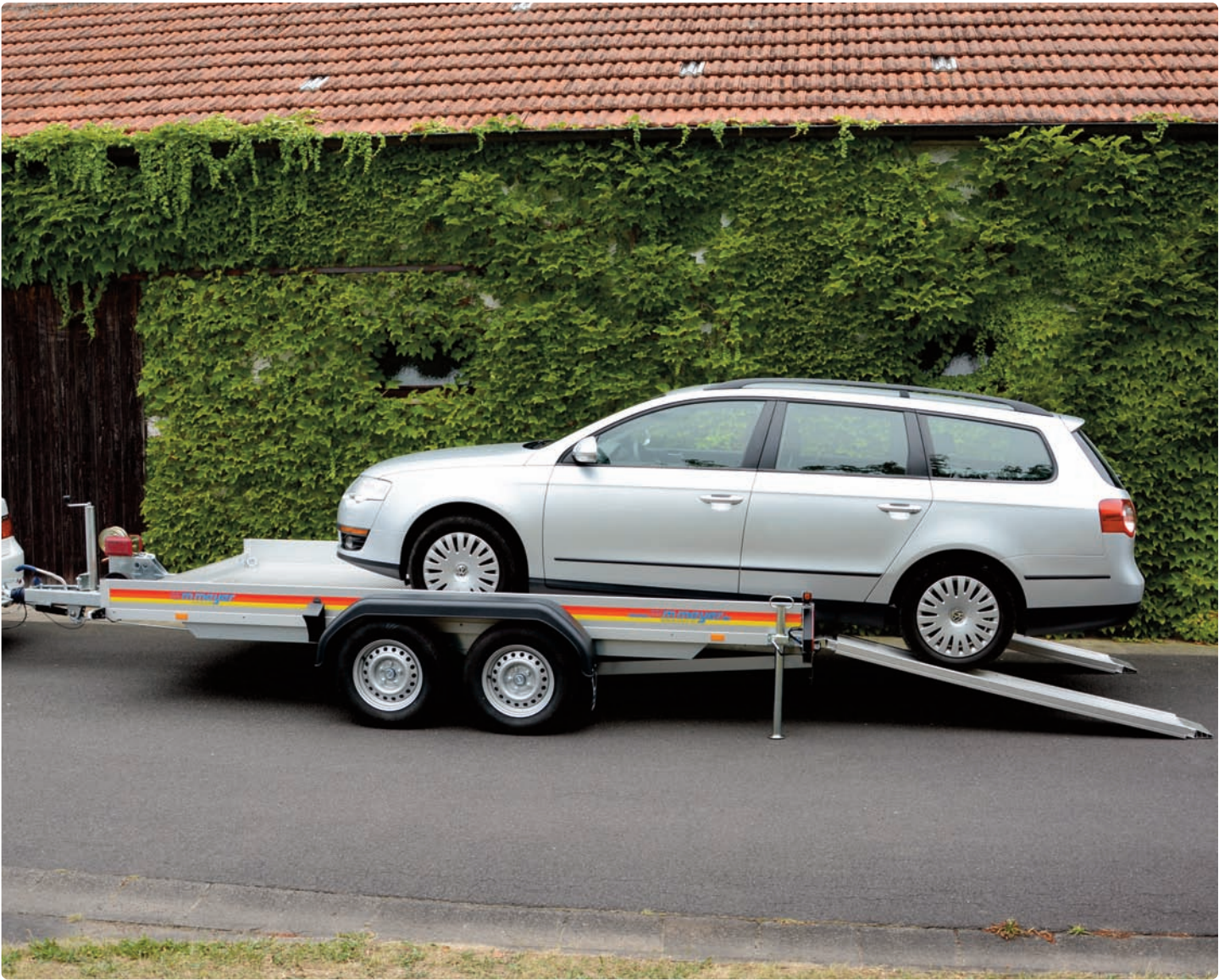
AP 2740/200 Aluprofilboden geschlossen, Stützrad verstärkt klappbar, 1-Gang-Seilwinde (900 kg, 12-m-Seil) und Windenbock AP 2740/200 Plancher intégral en profilés d'aluminium, roue jockey renforcée automatique, treuil 1 vitesse (900 kg, câble de 12 m) et support de treuil AP 2740/200 Closed aluminium platform, reinforced automatic jockey wheel, single-speed winch (900 kg, 12-m cable) and winch support
