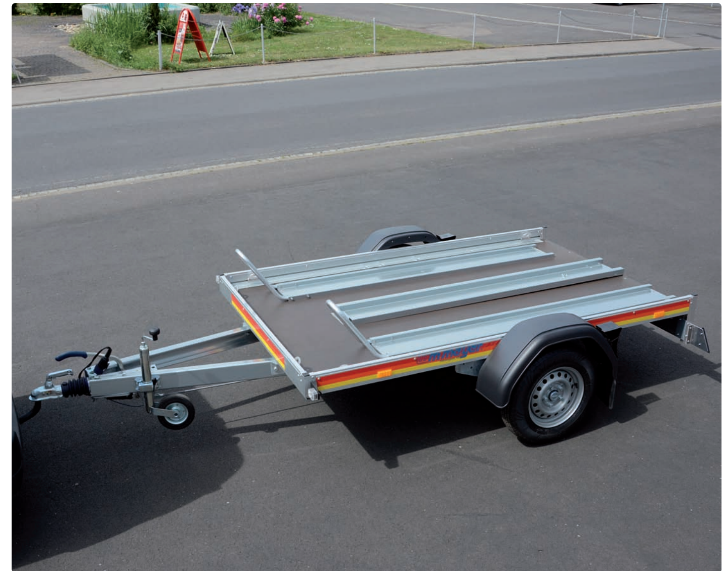
Mot 1025/151 Holzboden geschlossen, 2 Standschienen mit Bügel, 1 Auffahrschiene (Länge: 2.000 mm)
