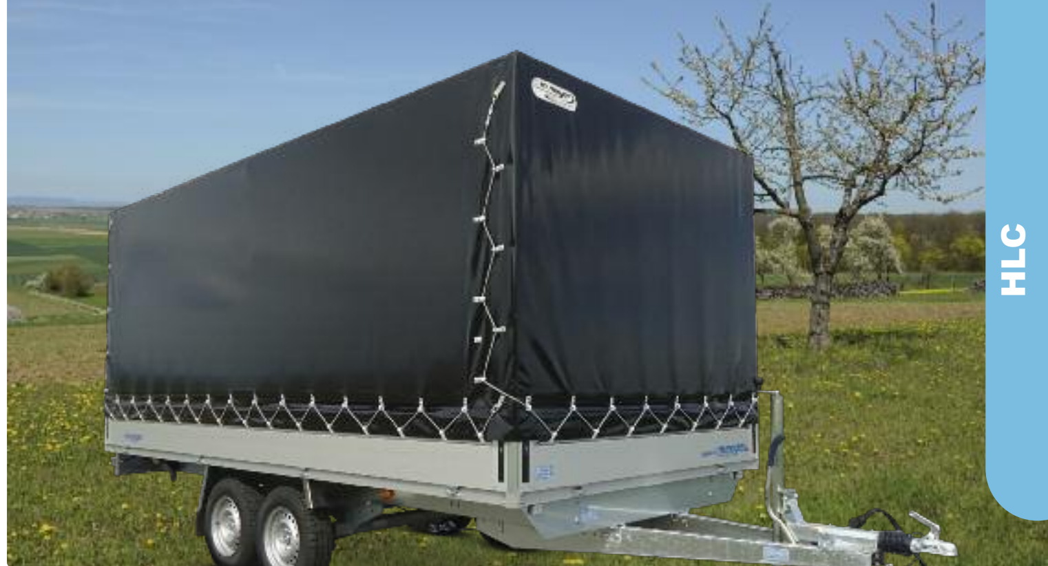
HLC 2746/210 Stützrad verstärkt, klappbar, mittig; Zubehör: Plane und Aluminiumspriegel HLC 2746/210 Roue jockey renforcée, automatique, au milieu du timon ; options : bâche et ossature en alu HLC 2746/210 Reinforced jockey wheel, automatic, in the middle of the drawbar; optional extra: canvas top, aluminium support
