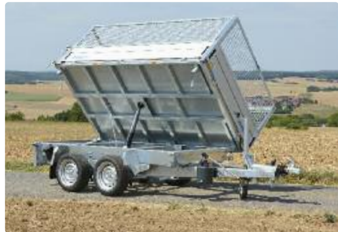
HKC 2726/155 Handpumpe, Zubehör: Stahlgitteraufsatz HKC 2726/155 Pompe hydraulique manuelle, option : rehausse grillagée HKC 2726/155 Manual hydraulic pump, optional extra: steel mesh extension
