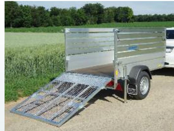
**HZ 7521/126 Zubehör:** Stahlgitterüberfahrwand, 2 Stützen, Alulaubaufsatzt
