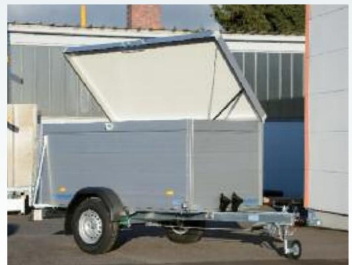
**B 1525/126 Zubehör:** 100 km/h, Sonderhöhe, Deckel
