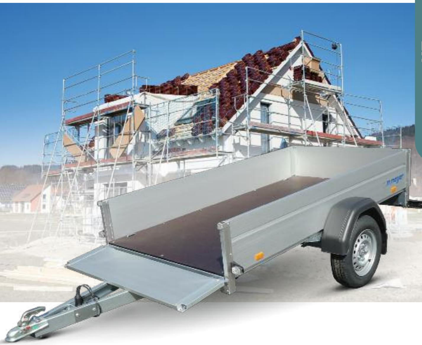
HZ 7575/126 Alubordwände eloxiert mit Sicke zur Planenbefestigung (Stärke: 25 mm, Höhe: 350 mm), Zubehör: Stirnwand klappbar
