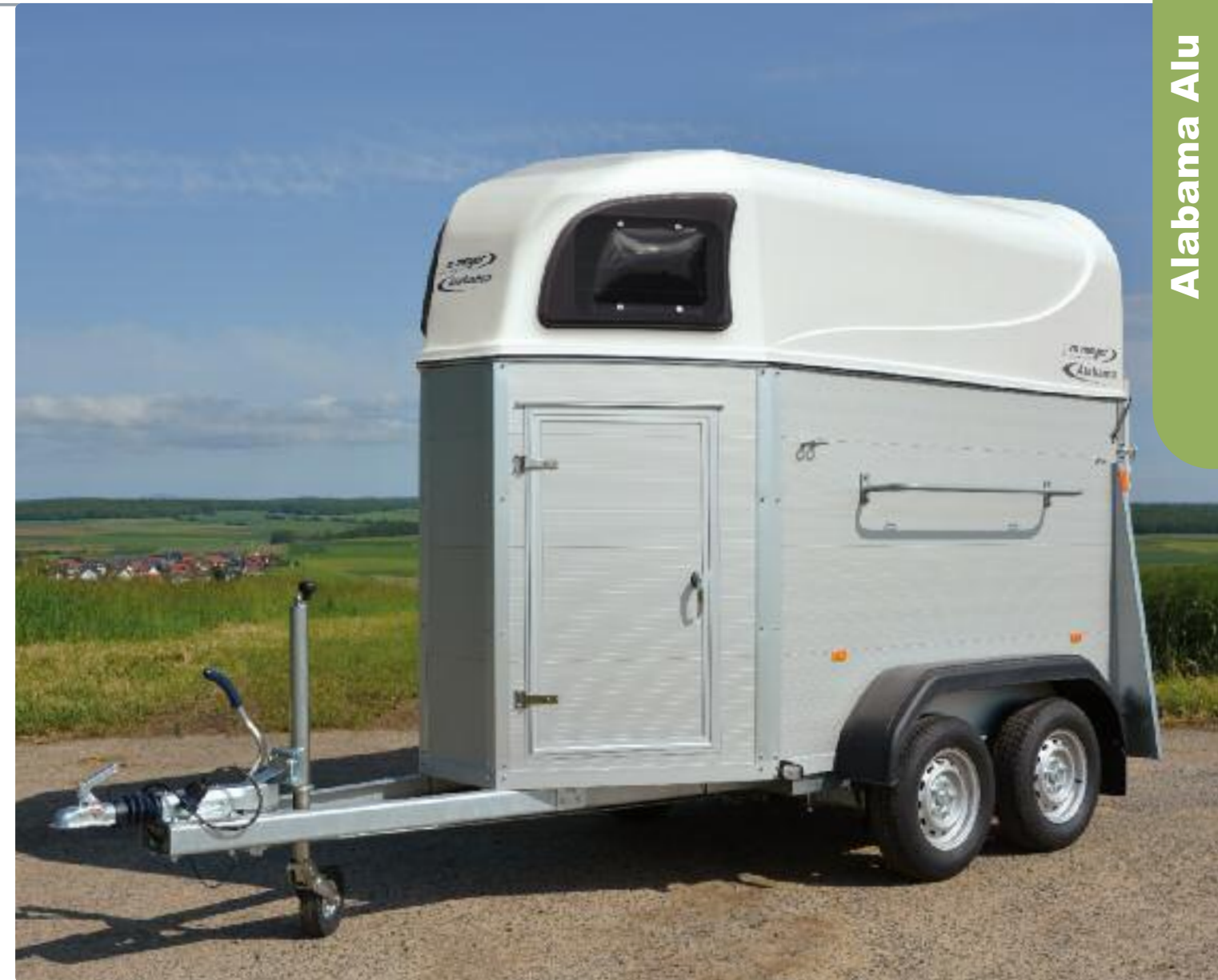
Stützrad verstärkt (klappbar, mittig), 2 Kunststoffkotflügel, Aluminiumwände; Zubehör: Sattelkammer Standard Alabama, Sattelablagestange Roue jockey renforcée (automatique, au milieu), 2 garde-boues en plastique, panneaux en aluminium ; options : sellerie standard Alabama, barre d'attache ext. Reinforced jockey wheel (automatic, in the middle), 2 plastic mudguards, aluminium side panels; options: standard saddle chamber Alabama, ext. saddle bar
