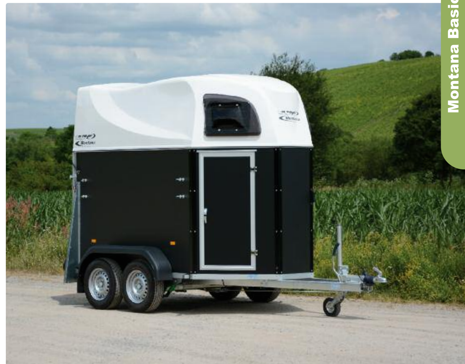
Stützrad verstärkt (klappbar, mittig), Holzwände (schwarz) Roue jockey renforcée (automatique, au milieu du timon), panneaux en bois (noir) Reinforced jockey wheel (automatic, in the middle of the drawbar), wooden side panels (black)
