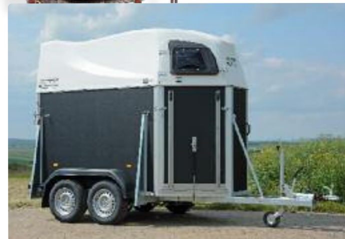
Montana Holzwände, Zubehör: Frontausstieg Montana Panneaux en bois, option : pont avant (avant à droite) Montana Wooden side panels, optional extra: front exit (front right)
