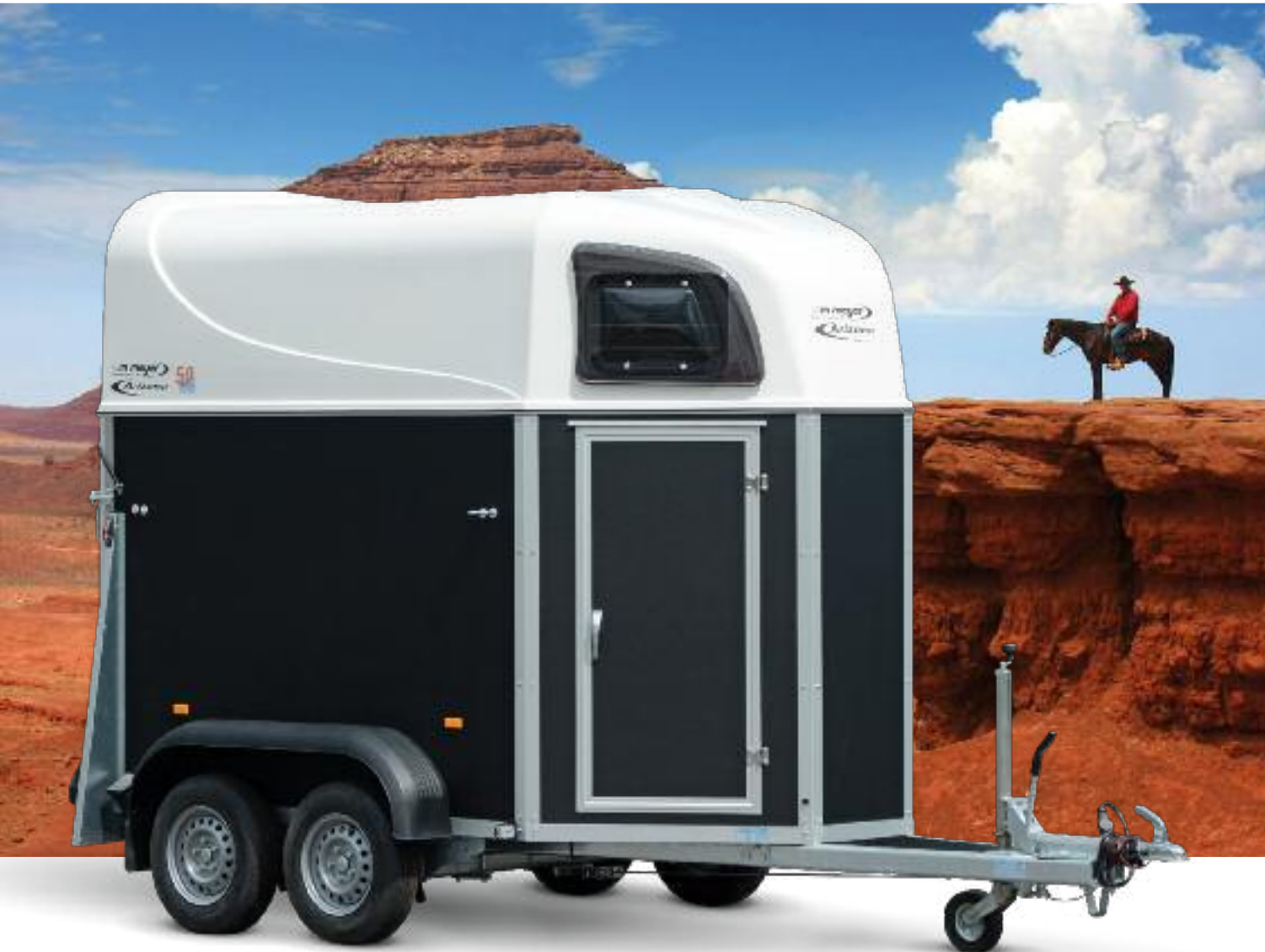
Arizona Holzwände (außen: schwarz, innen: weiß), Stützrad verstärkt (klappbar) Arizona Panneaux en bois (extérieur : noir, intérieur : blanc), roue jockey renforcée (automatique) Arizona Wooden side panels (exterior: black, interior: white), reinforced jockey wheel (automatic)
