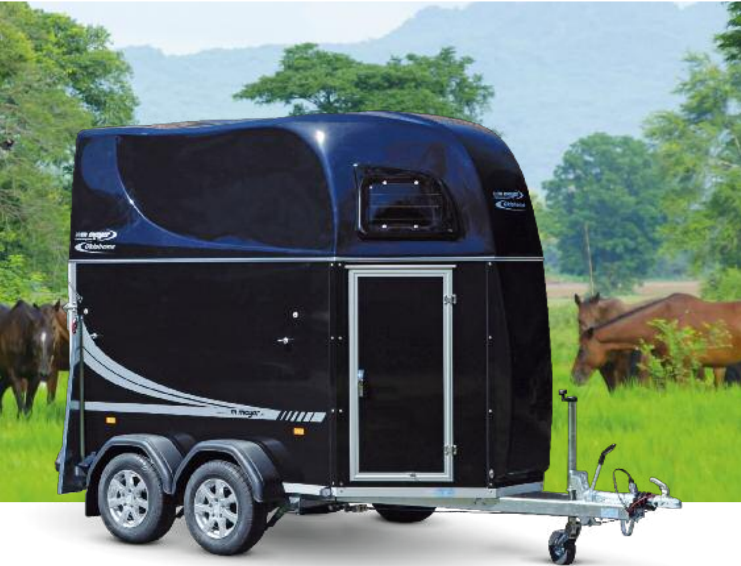
Oklahoma Tulsa Plus Innenlänge: 3.250 mm, Innenhöhe: 2.470 mm, Kunststoffeinzelfradkotflügel, Oklahoma-Beklebung A Oklahoma Tulsa Plus Longueur intérieure : 3.250 mm, hauteur intérieure : 2.470 mm, garde-boues individuels en plastique, autocollants Oklahoma (version A) Oklahoma Tulsa Plus Internal length: 3,250 mm (all models), internal height: 2,470 mm, separate plastic mudguards, Oklahoma stickers (A version)
