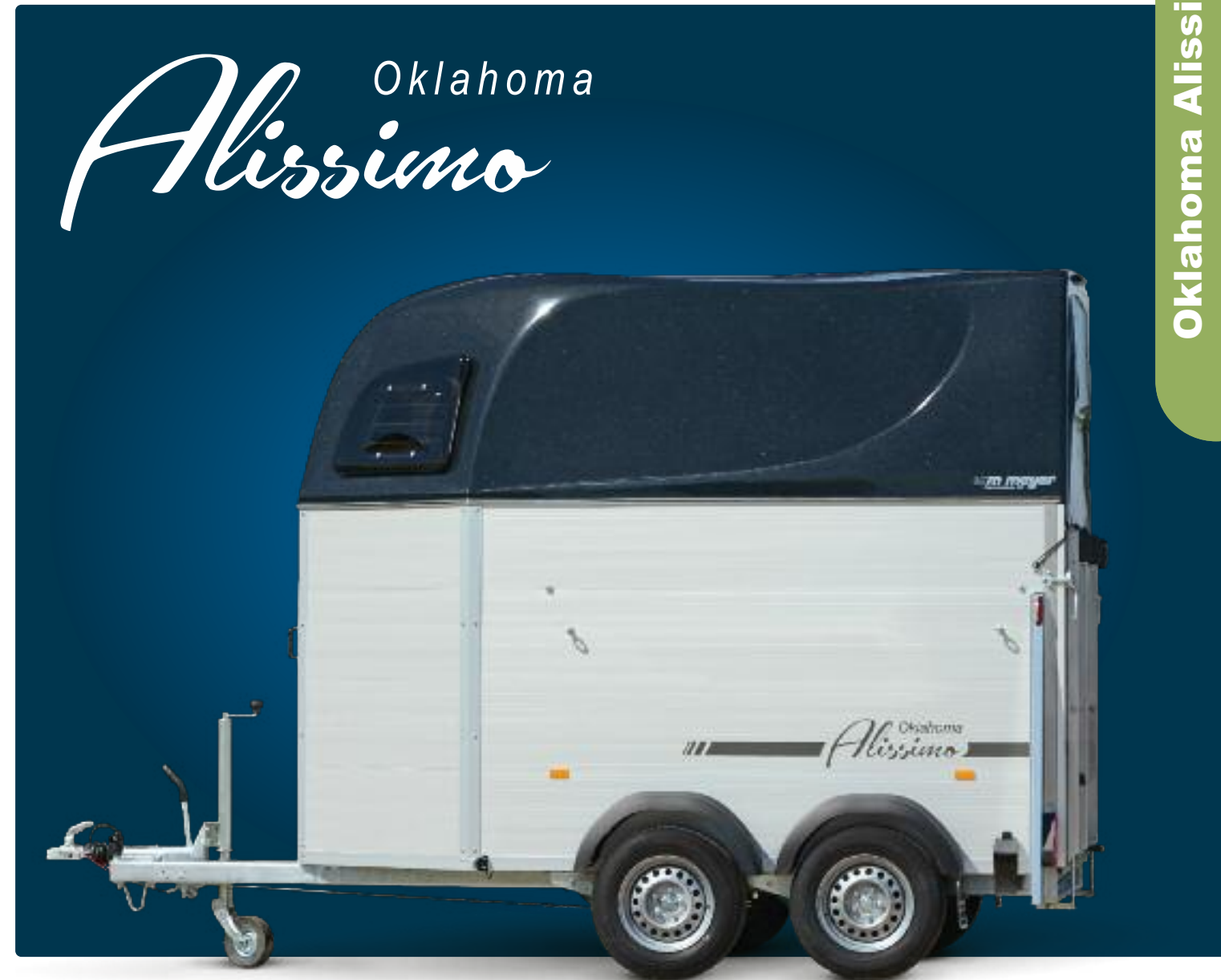
Stützrad verstärkt (klappbar), Aluminiumwände, Polyesterhaube (schwarz) Roue jockey renforcée (automatique), hardtop en polyester (noir) Reinforced jockey wheel (automatic), polyester hardtop (black)
