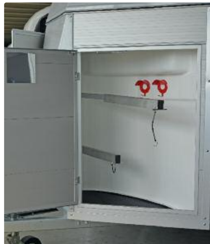
Zubehör: Sattelkammer Groß inklusive Sattelablagegestange Option : Grande sellerie avec barre d'attache Optional extra: Grand saddle chamber with exterior saddle bar
