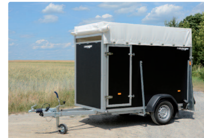
V 1325/129 Eckig, Zubehör: Hochplane und Aluspriegel V 1325/129 Panneau avant plat, option : bâche haute et ossature en alu V 1325/129 Flat front panel, optional extras: high canvas top and aluminium support
